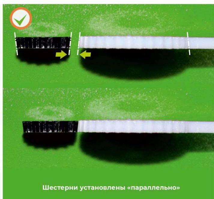
Шестерни установлены «параллельно»
