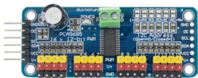
16-канальный 12-битный ШИМ-контроллер на основе микросхемы PCA9685
