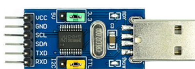
USB-I2C конвертер на основе микросхемы CH341T
